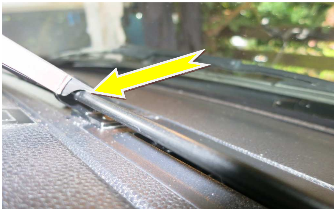
Der untere Teil des Adapters stützt auf Führungsrohr auf. (Bild: Söncksen)
