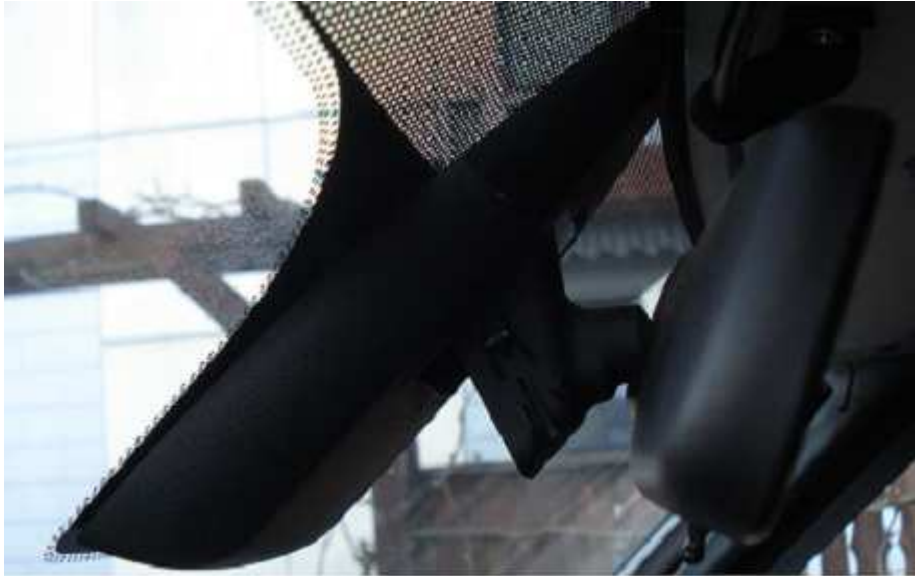
Hier wurde die Verkleidung abgesägt und teilweise neu verklebt. (Bild aus Internet)
