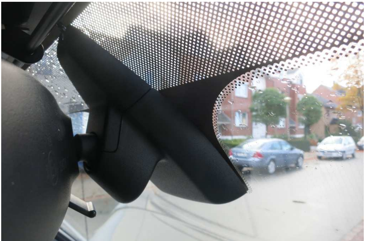
Hier wurde die Verkleidung des Licht-und Regensensors nicht verändert. (Bild: Söncksen)
