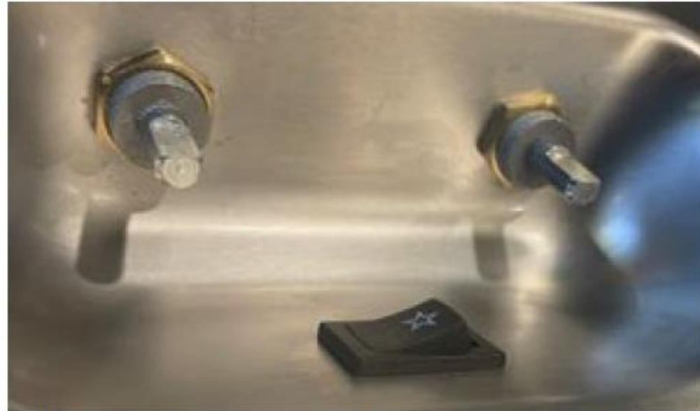
Bild 2b: Gasregler-Schaft in Aluminium – in Ordnung
