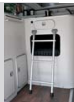
Aufstiegsleiter zum Dachbett
