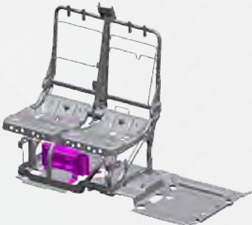
JZXAD - Installationsort für den intelligenten Sicherungskasten
