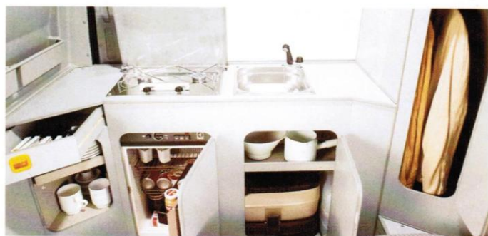
Der Küchenblock des Nugget W mit Gaskocher, Spülbecken und Kühlschrank.
