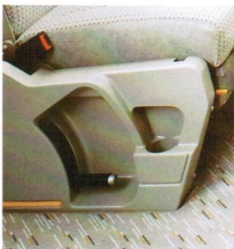
Mit einem leicht zu bedienenden Hebel läßt sich die Rückenlehne der Sitzbank verstellen.
