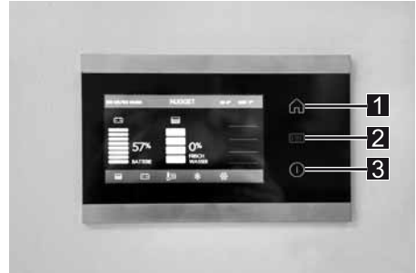
Zentral-Elektronik mit seitlichen Bedientasten
