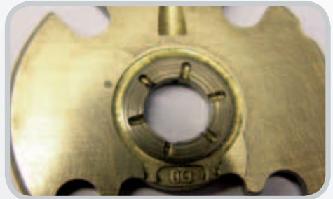
Axialagerverschleiß durch verschmutztes Öl
