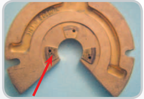
Ölmangelschaden am Axiallager
