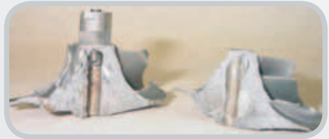
Durch Überdrehzahl geborstenes Verdichterrad
