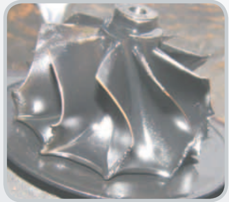
Fremdkörperschaden am Turbinenrad
