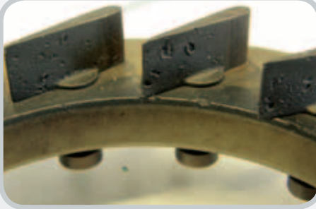
Fremdkörperschaden an den Leitschaufeln der variablen Turbinengeometrie
