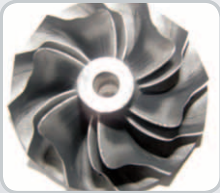
Verdichterradschaden durch Staub, Sand oder Schmutz
