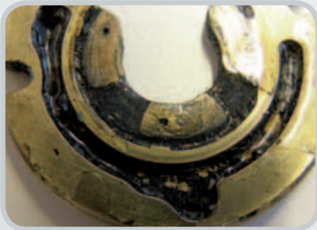
Axiallager mit Ölkohleablagerungen
