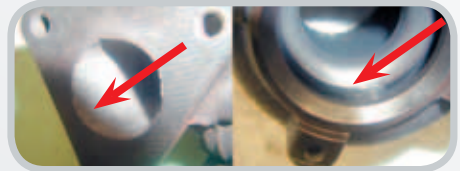
Ein kapitaler Motorschaden führte zur Zerstörung des Turboladers. Geschmolzenes Aluminium setzte sich in allen Abgaskanälen des Turbinengehäuses fest.
