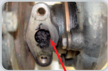
Starker Ölkohleaufbau im Lagergehäuse
