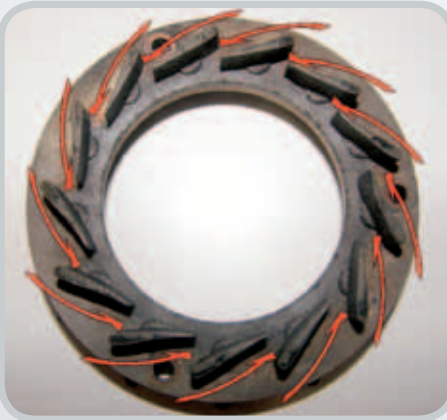
Abgasstromverlauf am Leitring der VTG
