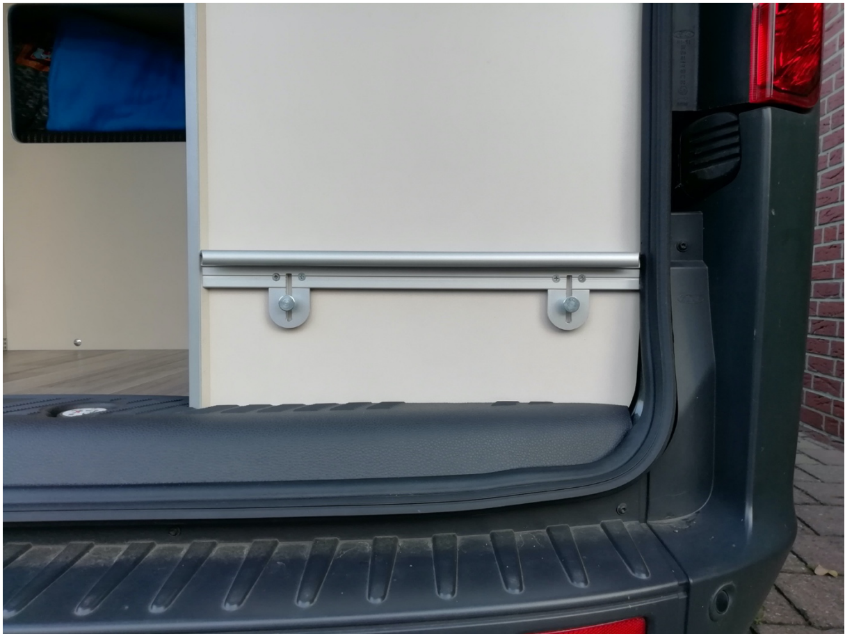
Die gekürzte Ersatzschiene ist am Kleiderschrank verschraubt. Das Profilscharnier am Kleiderschrank ist auch in der Höhe verstellbar.
