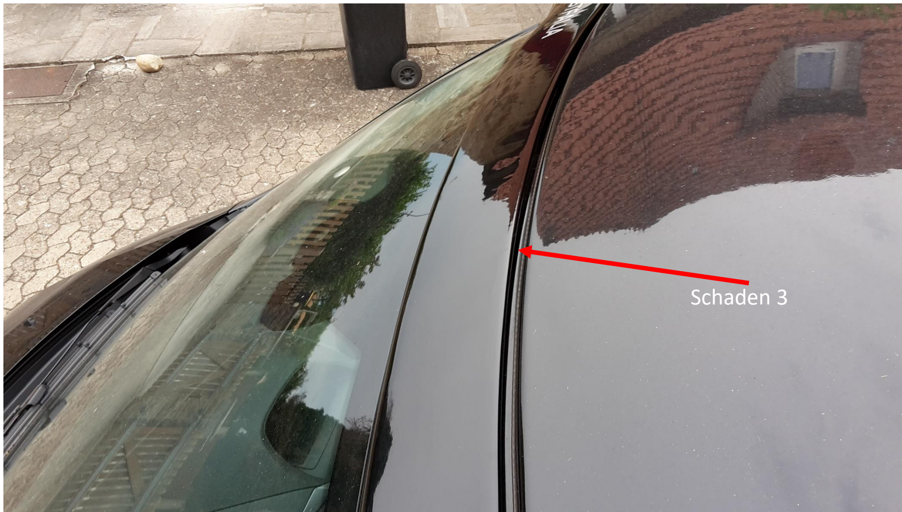
Sicht auf Spoiler mit Schadstelle 3 (Hinterseite Spoiler)
