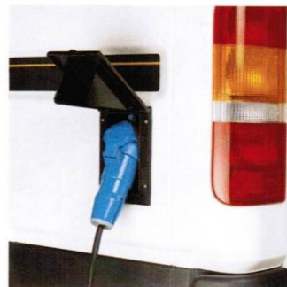
Die CEE-Außensteckdose (220 V) im Nugget W.
