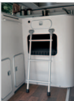
Aufstiegsleiter zum Dachbett
