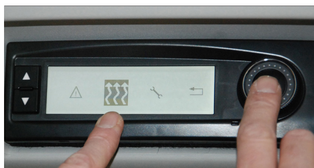
Bild 12: Im Service-Menü das Heizungssymbol auswählen.
