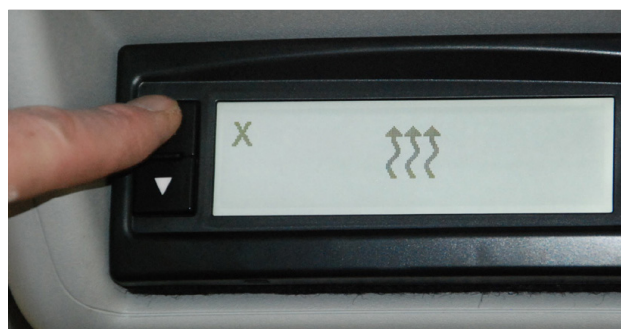
Bild 13: Störungsmeldung zum Heizungsfehler quittieren.
