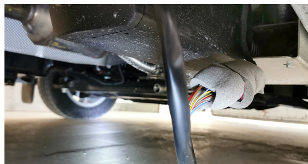
Bild 15: Heizungsstecker aus dem Zwischenraum herausziehen
