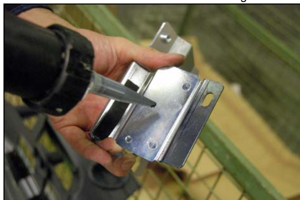
Abb.: Klebestellen vorbereiten und Sika auftragen
