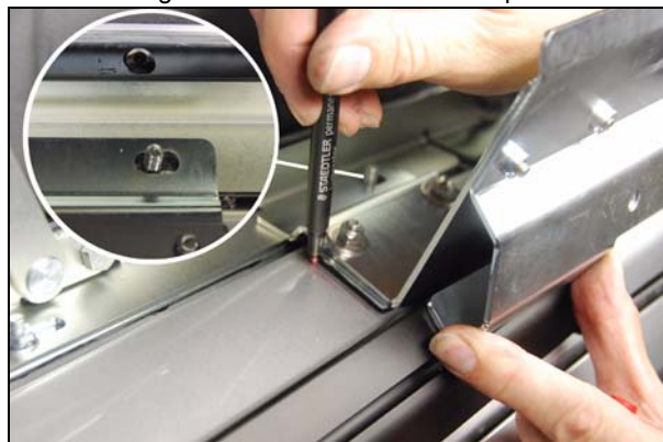
Abb.: Klebestellen vorbereiten und Sika auftragen
