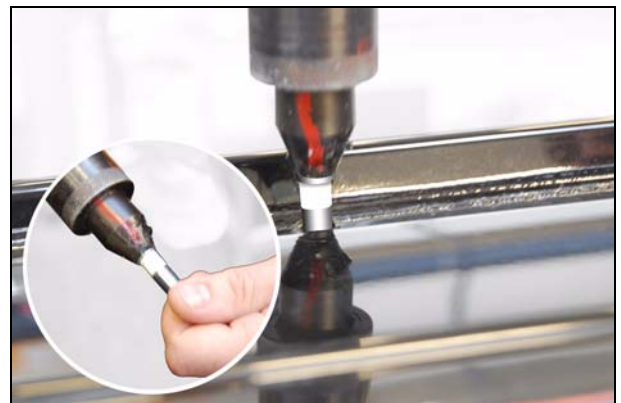
Abb.: überschüssiges Sika entfernen
