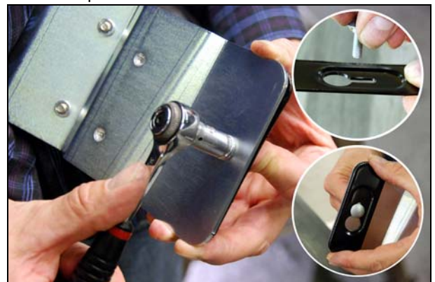
Abb.: Klebefläche für die Stützplatte markieren
