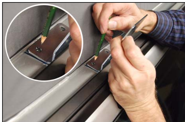
Abb.: Bohrlöcher anzeichnen
