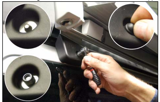
Abb.: Unterlegscheibe, Mutter festschrauben, Abdeckkappe
