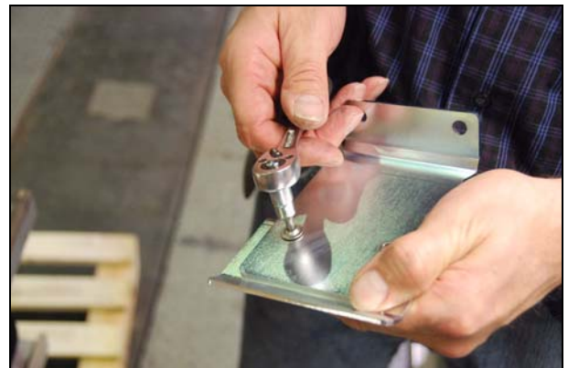
Abb.: Stützplatte unterschrauben
