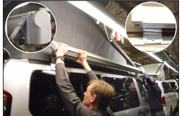
Abb.: vorne und hinten die Bohrlöcher anzeichnen
