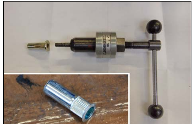
Abb.: Einziehmutter vernieten
