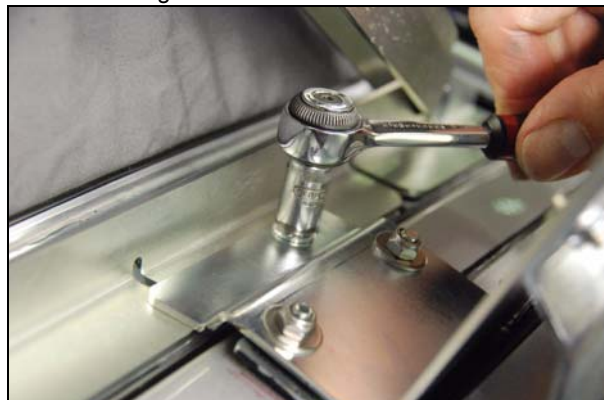
Abb.: Außenhalter herunterdrücken und festschrauben
