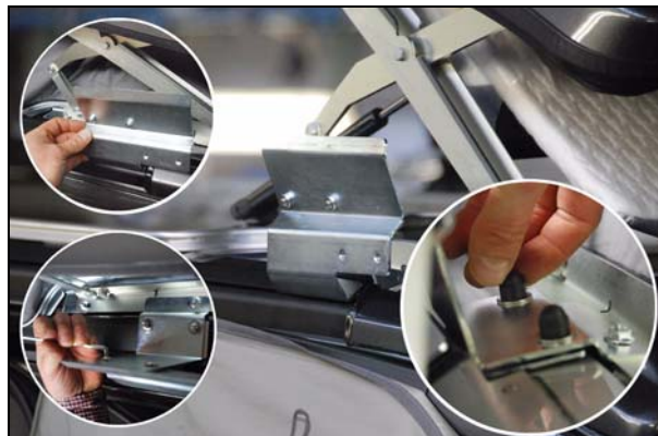
Abb.: Markierung 331 mm von der Hinterkante anzeichnen
