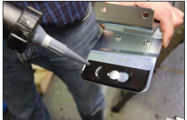
Abb.: Halterung festschrauben, Unterlegscheibe aufschieben
