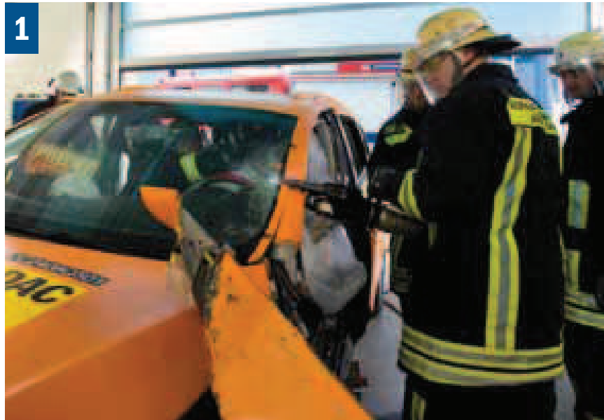
Abtrennen der Fahrertür und Durchtrennen der A-Säule
