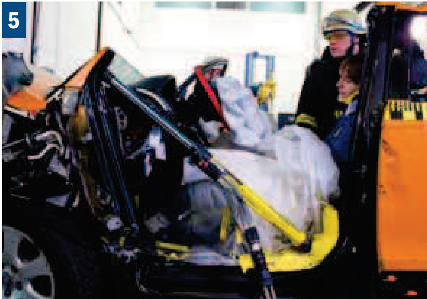
Erweitern des Fußraums durch Rettungszyylinder
